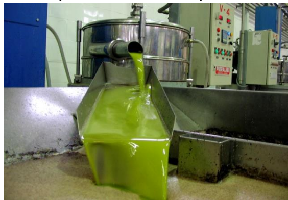
Segundo centrifugado y separación de fases (líquido y sólido)
