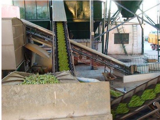
Se transportan en cinta y se ventean
