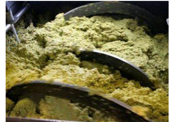
Se muele la oliva entera con el carozo y luego se bate.
